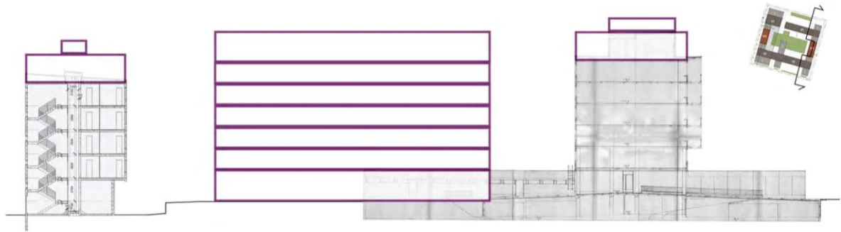
Kuva 18. Luonnosvaiheen vaihtoehto 1. Korttelileikkaus. Täydennysrakentaminen on osoitettu violetilla. Ramboll Finland Oy 19.11.2020.
